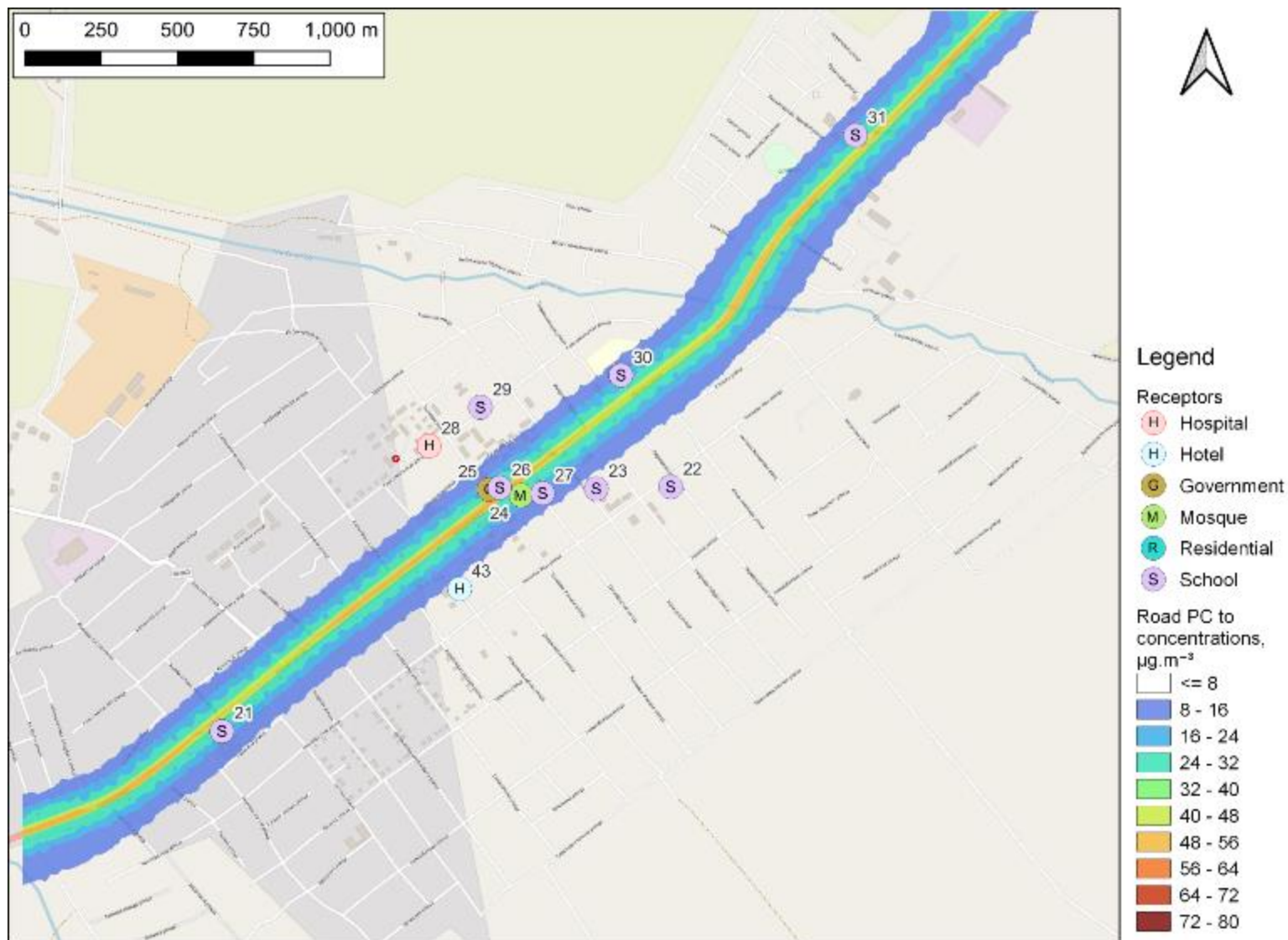
Рисунок 1-44: Дорожный ПК до максимальной средней концентрации PM_{2.5} за 1 час с проектом, 2047: Кызыл Суу, \mu\text{g.m}^{-3}
