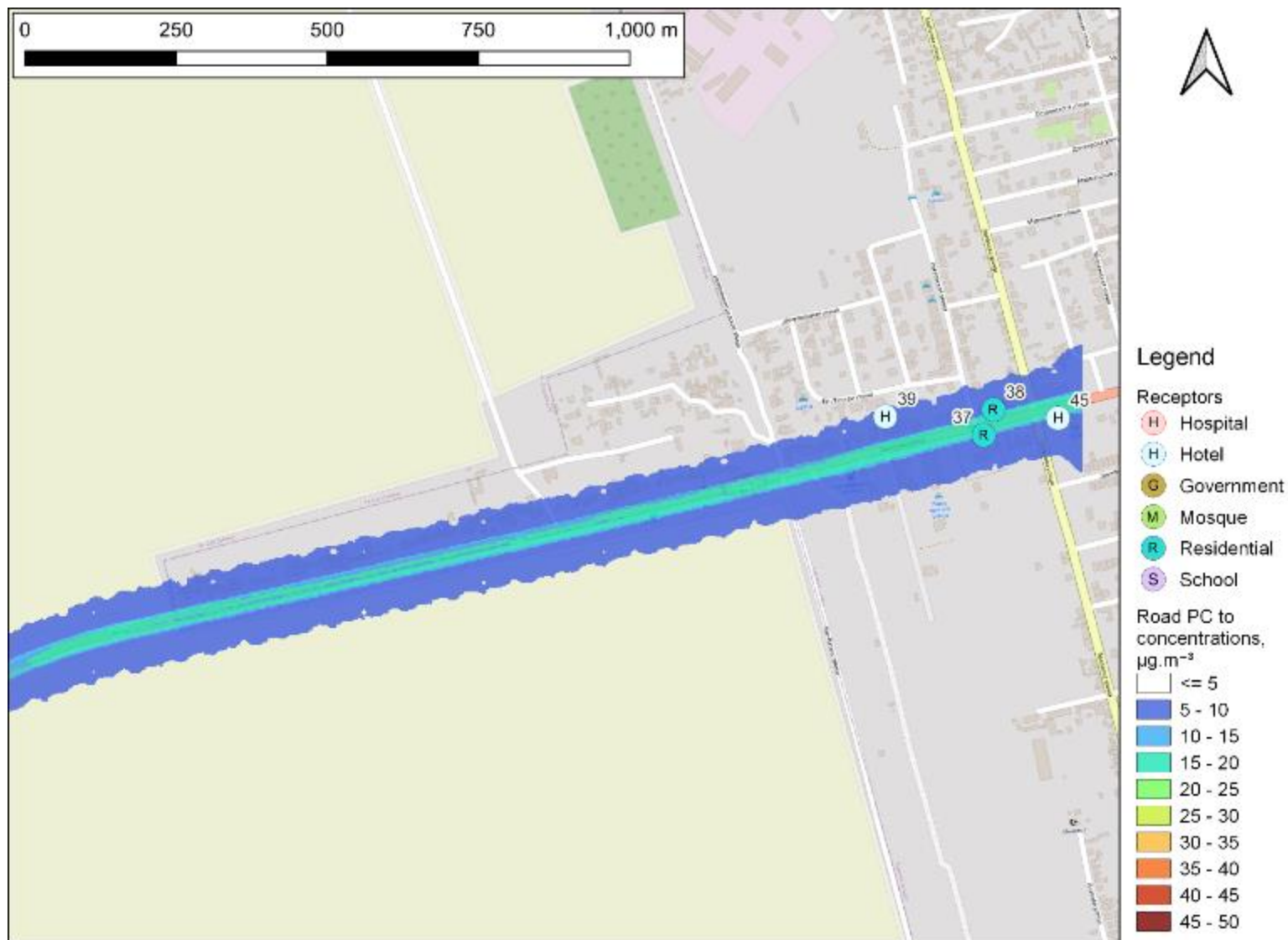
Рисунок 1-24: Дорожный ПК для достижения максимальных средних 24-часовых концентраций \text{NO}_2 с проектом, 2027: Каракол, \mu\text{g}\cdot\text{m}^{-3}
