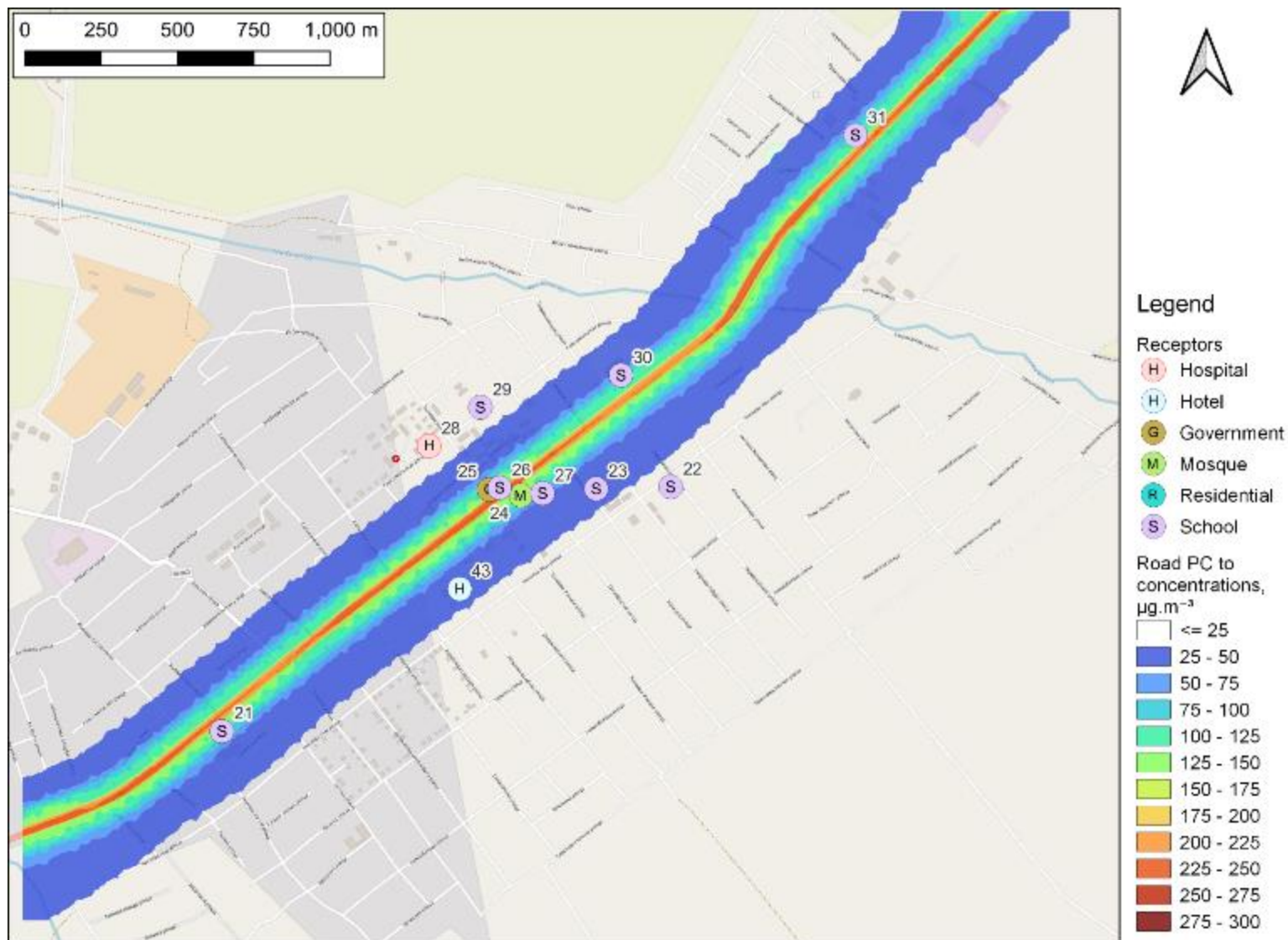
Рисунок 1-35: Дорожный ПК до максимальной средней концентрации PM_{10} за 1 час с проектом, 2047: Кызыл Суу, \mu\text{g}\cdot\text{m}^{-3}
