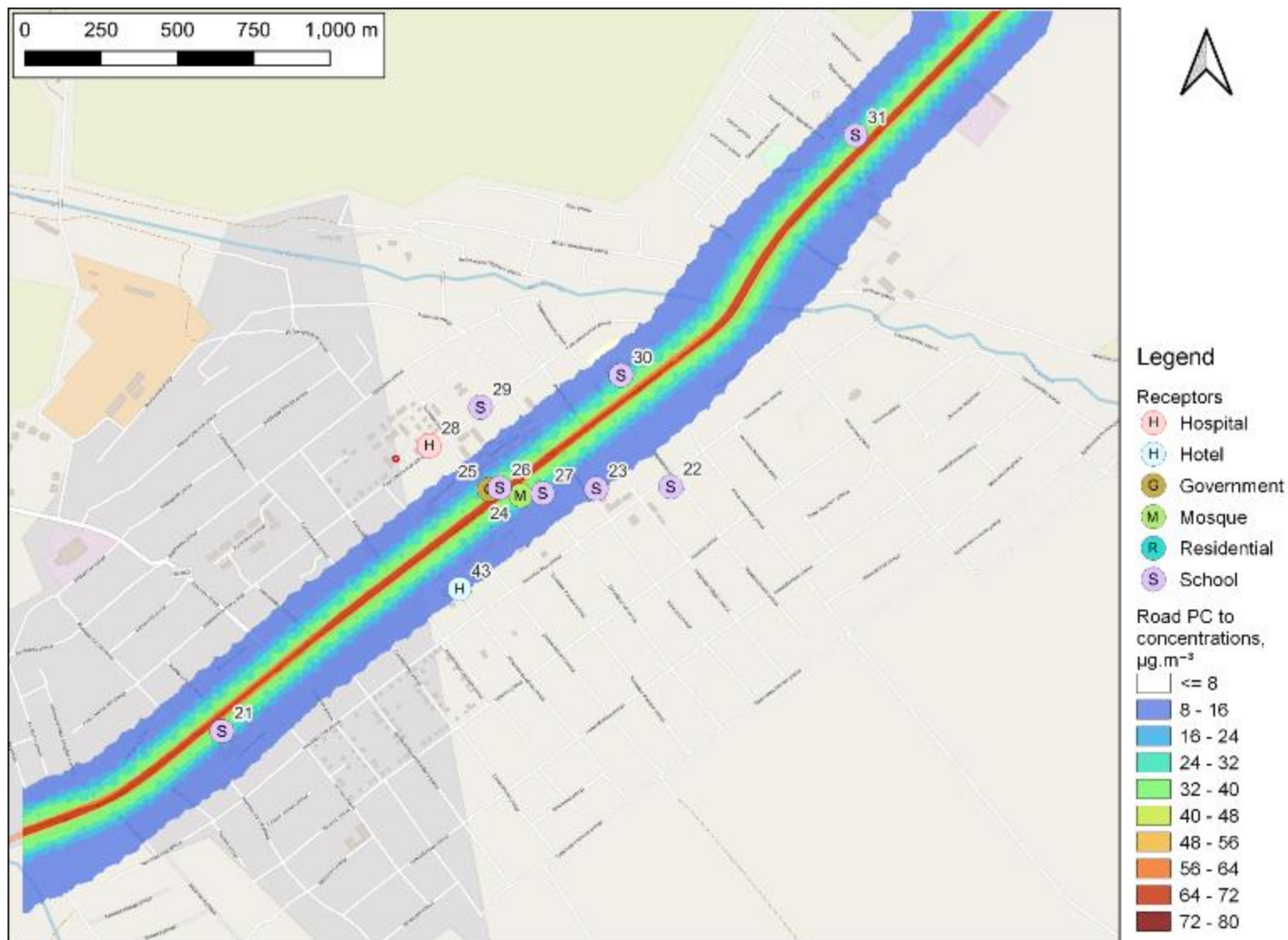
Рисунок 1-17: Дорожный ПК до максимальной средней концентрации PM_{2.5} за 1 час с проектом, 2027: Кызыл Суу, \mu\text{g.m}^{-3}
